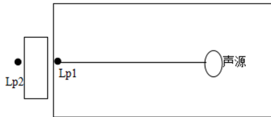
图 4-3 室内声源等效为室外声源图例
